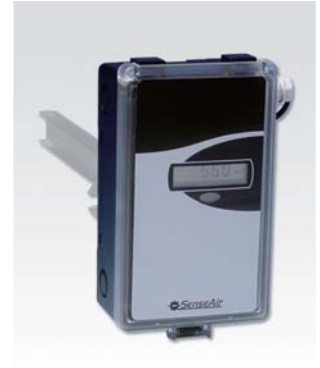
040-8-0024 aSENSE ® VAV-Duct-Disp ダクト型IP65ディスプレイ付 H142×W84×D46mm プローブ長さ: 245mm(調整可)
