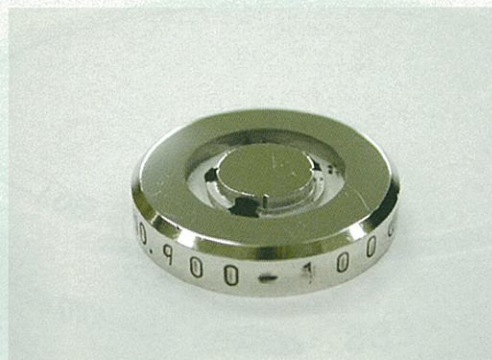
ナノインデンテーション用単結晶製超微小硬さ 基準片試作品φ25mm（W，硬さ約400HV）
