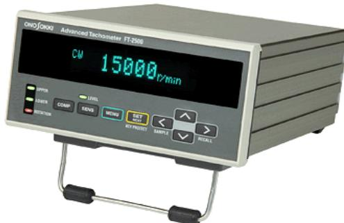
高级转速表FT-2500，是通过检测马达及各种旋转机械的噪音或振动、或磁力线的变化，测量其转速的转速表。
